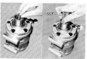
INSTALL KEY IN SHAFT GROOVE
